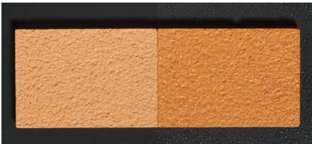
► Une même mise en œuvre, une seule référence d'enduit sec ou mouillé = deux aspects colorés
